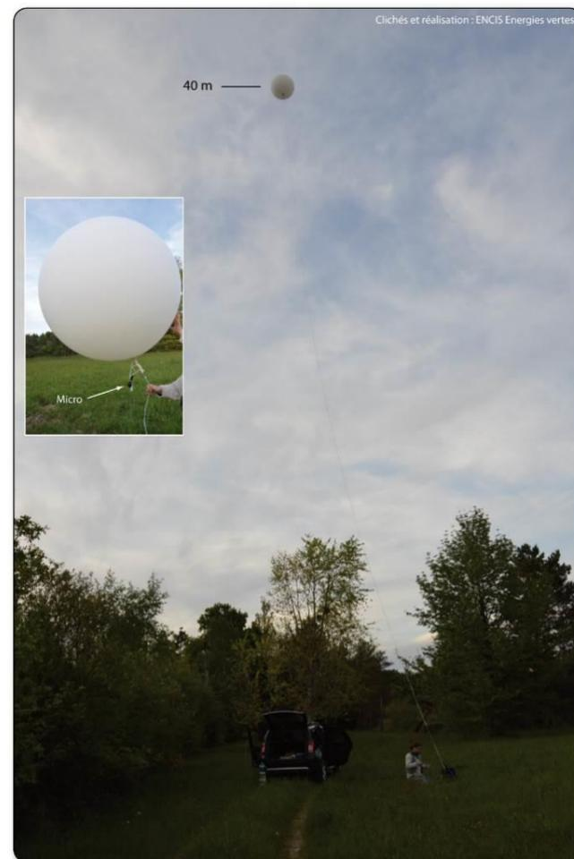
Photo 1 : Exemple de dispositif SM2Bat installé avec le ballon-sonde
